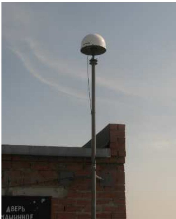
Рис.1. Закрепление фазового центра антенны
